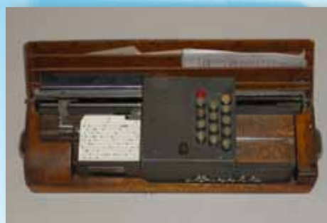
Perforatrice Bull P80 et cartes perforées. Cette machine de comptabilité est composée de la perforatrice manuelle des cartes perforées, de la tabulatrice (lisant les cartes et imprimant les résultats) et de la trieuse de cartes. Quoique rudimentaire, cette machine trouvait sa place dans tous les ateliers de mécanographie et même, plus tard, près des ordinateurs à lecteurs de cartes. Fabriquée entre 1945 et 1965.
